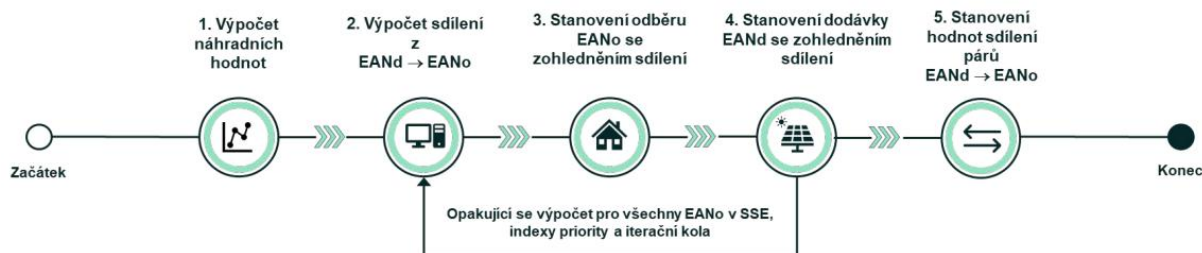
Obrázek 27 Schéma stanovování spotřebních hodnot ve sdílení (Zdroj: EDC)
